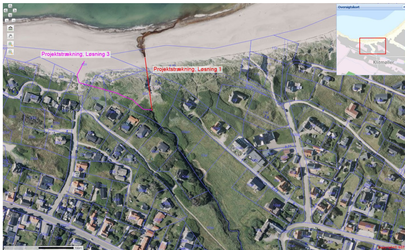
Kortbilag: Oversigtskort med projektforslag på hele området. Den røde strækning angiver det nye vandløbstracé (genåbning i eksisterende tracé, Løsningsforslag 1). Den lyserøde strækning angiver Løsningsforslag 3.
